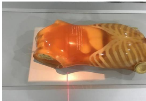
Gambar 4.10 Posisi phantom AP lumbal dan pelvis kolimasi 35x43 cm
