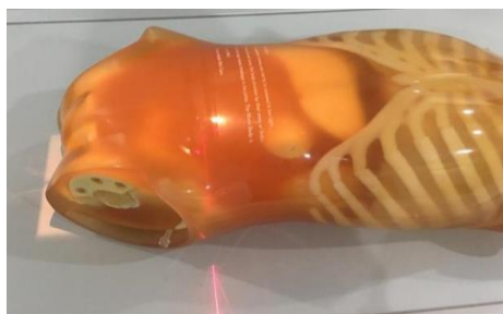
Gambar 4.8 Posisi phantom AP lumbal kolimasi 18x43 cm
